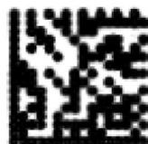
Le remplissage des cellules est le pourcentage de remplissage de la cellule idéale. L'exemple ci-joint montre un marquage par percussion qui sur-remplit les cellules. Le marquage dépasse les frontières de cellules.
