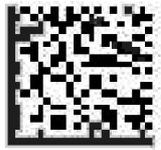
La modulation des cellules qualifie l'uniformité de la réflectance des éléments clairs et foncés du symbole. L'exemple joint montre un symbole obtenu par percussion dont la réflectance de certains éléments n'est pas homogène.
